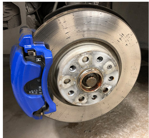
Hjulet avtaget på en bil med skivbroms. Bromsoket är den blå delen som ligger över skivan.
